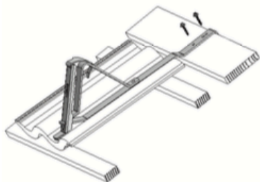
Рис. 31 Крепления снегозадерживающих решеток устанавливаются на дополнительную обрешетку (доску)
