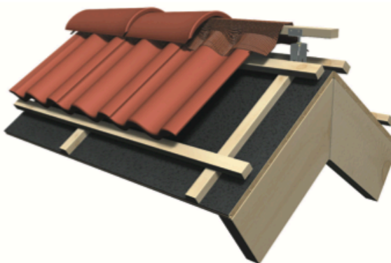
Рис. 13 Коньковая черепица должна опираться на деревянный брусок и рядовые черепицы.
