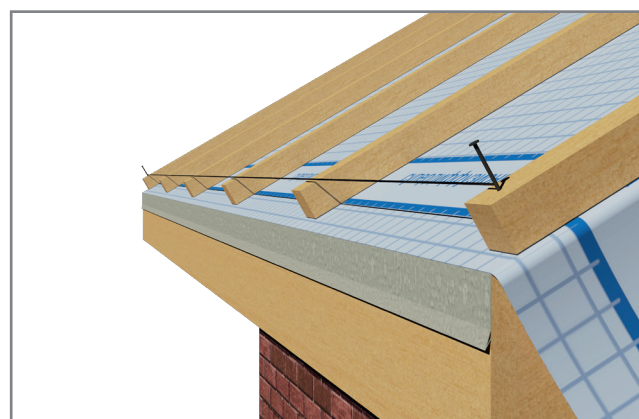
Рис 8.5.1 Разметка промежуточных точек плоскости ската
