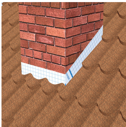
Рис 9.5.2 Монтаж комбинированной черепицы в месте примыкания
