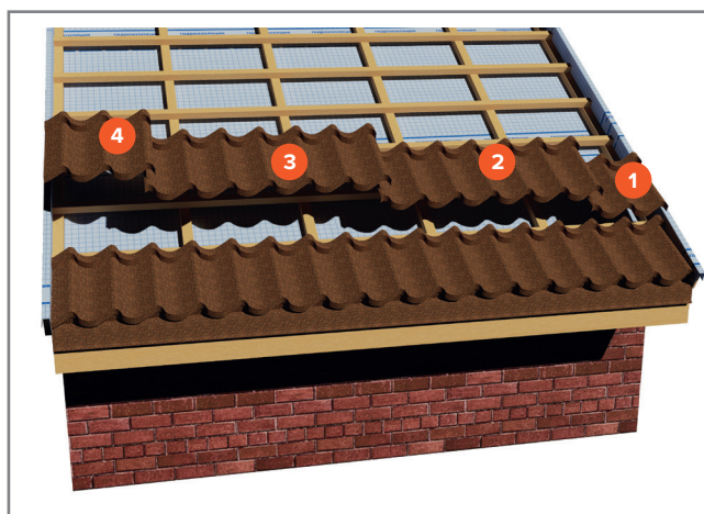
Рис 9.1.11 Монтаж следующих рядов
